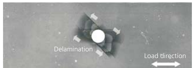
CFRP積層板の円孔まわりのはく離進展
