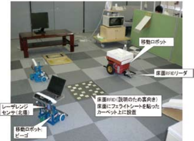
写真1 知能化空間におけるRTユニット
