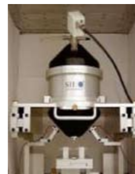
図 1 小動物用 SQUID システム
