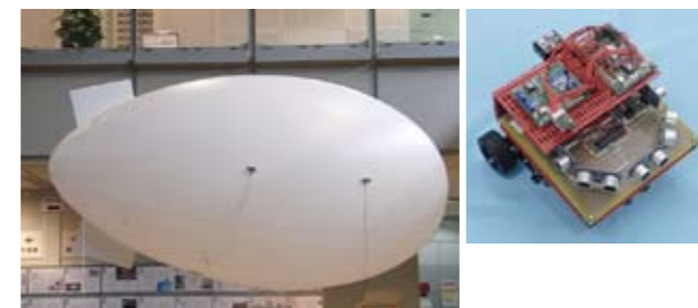
写真2 飛行船と移動ロボットによる3D群知能システム
