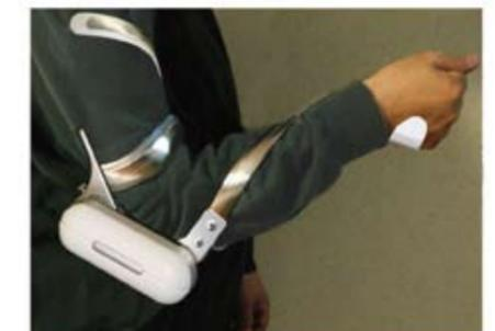
写真6 振戦抑制ロボットシステム
