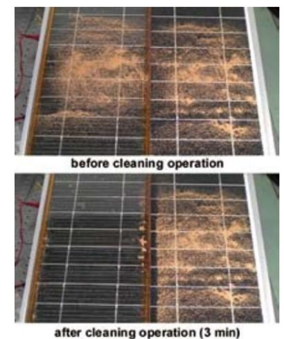
図4 静電クリーニングの実証実験
