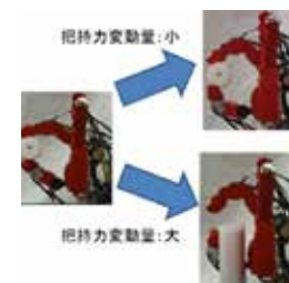
写真4 把持力変動量に基づく操り軌道の変更
